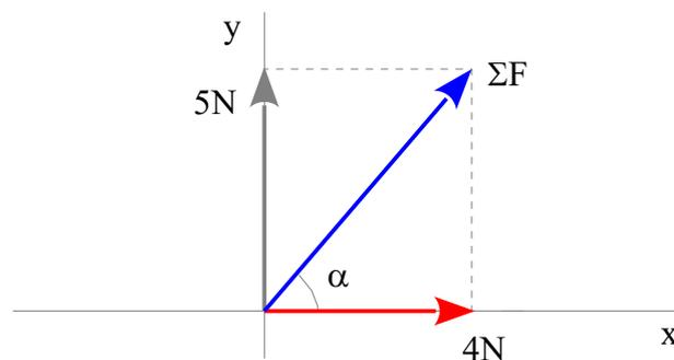
La resultante es la diagonal del paralelogramo formado con ambas fuerzas. La diagonal la calculamos con el Teorema de Pitágoras.
