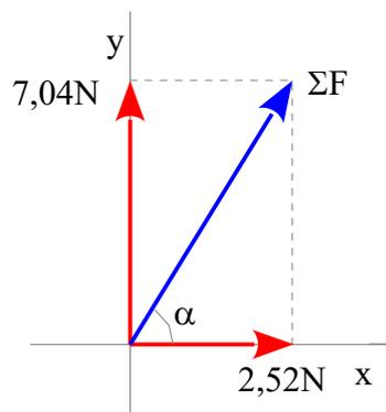
La resultante es la diagonal del paralelogramo formado con ambas fuerzas. La diagonal la calculamos con el Teorema de Pitágoras.
