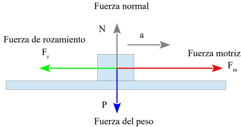
Según la segunda ley de Newton si el cuerpo se mueve con aceleración constante la resultante es igual al producto de la masa por la aceleración. En la dirección vertical no hay aceleración, la resultante es cero, por tanto la fuerza normal, N, y el peso, P, deben ser iguales, de la misma dirección y de sentidos contrarios.
