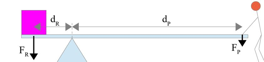
Ley de la palanca: En la palanca el producto de la fuerza por su brazo se mantiene constante.
