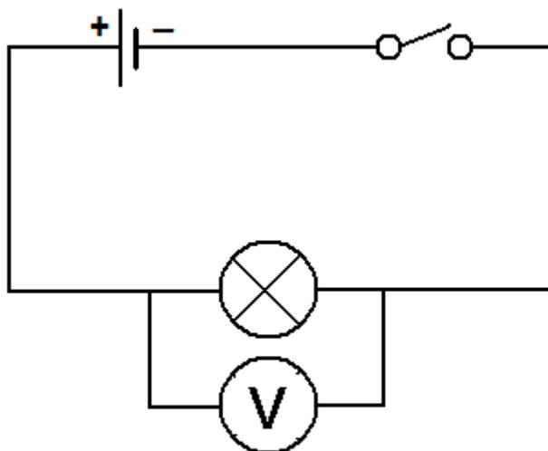
La unidad de diferencia de potencial es el voltio y se representa por V. Entre dos puntos de un circuito hay una diferencia de potencial de un voltio si para transportar entre ellos un culombio de carga necesitamos realizar el trabajo de un julio.
