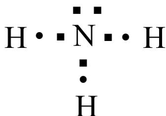
Para la estructura de puntos pintamos unos círculos que abarquen los electrones propios y los que necesitan pedir para conseguir configuración de gas noble. El H necesita pedir 1 electrón. El N necesita pedir 3 electrones.
