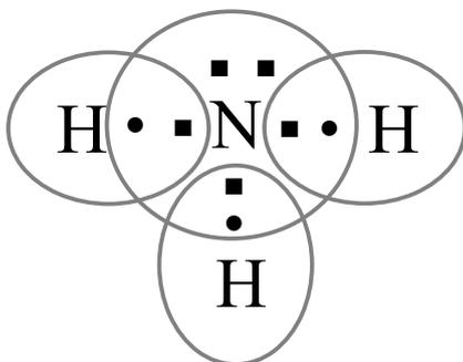
Para la estructura de barras pintamos un barra por cada dos electrones que se comparten o por cada dos electrones que rodeen a un átomo, los primeros son los pares de enlace y los segundos los pares no enlazantes. El H está rodeado de un par de electrones, configuración de gas noble. El N está rodeado de 4 pares de electrones, configuración de gas noble.
