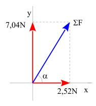
La resultante es la diagonal del paralelogramo formado con ambas fuerzas. La diagonal la calculamos con el Teorema de Pitágoras.
