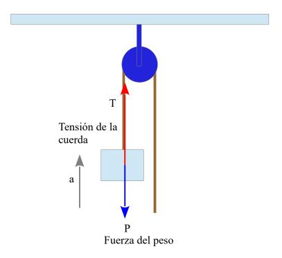
Según la segunda ley de Newton si el cuerpo se mueve con aceleración constante la resultante es igual al producto de la masa por la aceleración. La tensión de la cuerda tiene que ser mayor que el peso.
