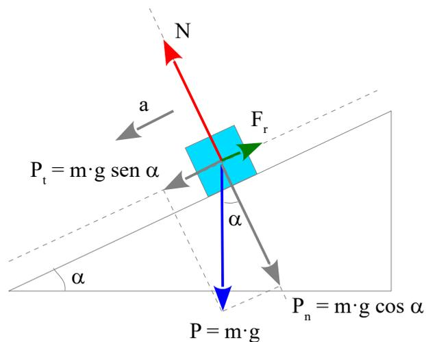
Según la segunda ley de Newton si el cuerpo se mueve con aceleración constante la resultante es igual al producto de la masa por la aceleración, por tanto la resultante será la componente tangencial del peso,  $P_t$ , menos la fuerza de rozamiento,  $F_r$ , y debe ser igual al producto de la masa por la aceleración.
